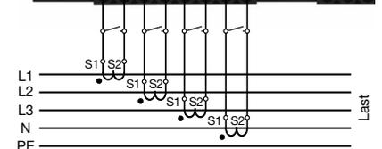
Abb. Anschlussbeispiel „Strommessung“.
