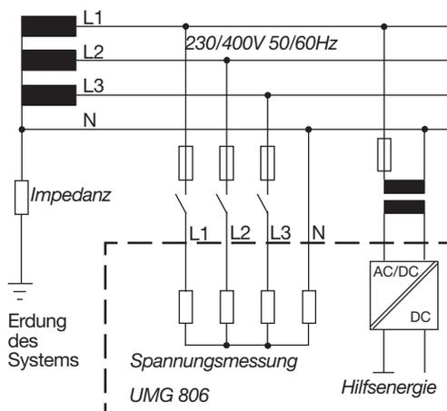
Abb. Prinzipschaltbild, UMG 806 im IT-Netz mit N.
