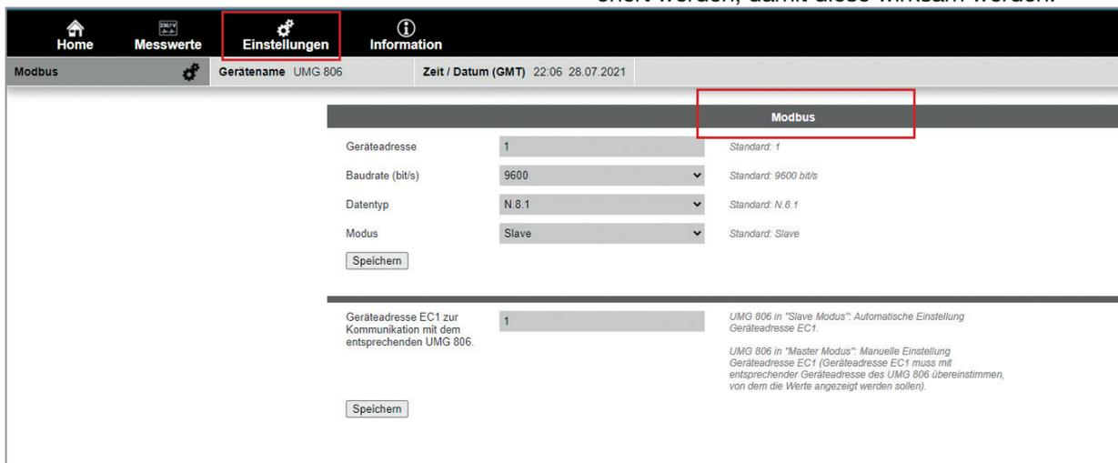
Abb. Beispiel für Modbus Einstellungen für das Gerät UMG 806
