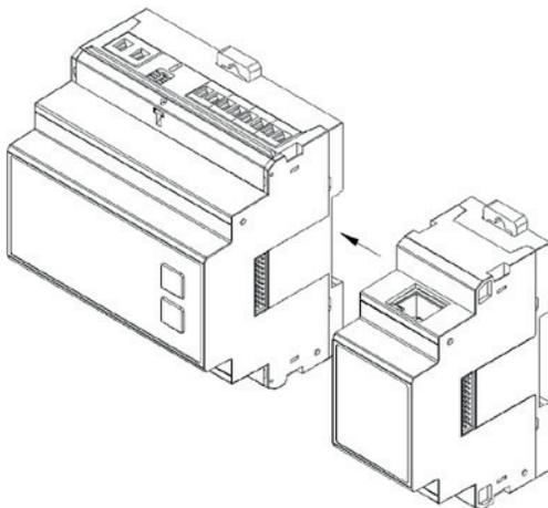
4. Prüfen Sie die Verbindung des UMGs zum Modul!
