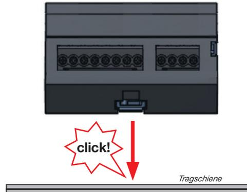
Abb. Montage auf Tragschiene
