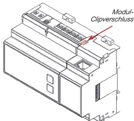
5. Arretieren Sie das Gerät zusammen mit dem Modul an der Ober- und Unterseite mit den Modul-Clipverschlüssen.
