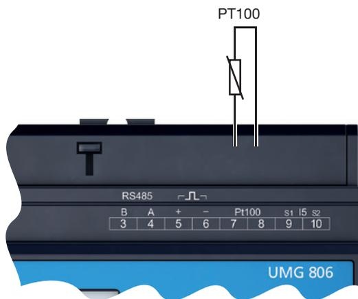
Abb. Anschlussbeispiel „Temperaturmessung“.
