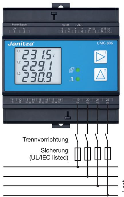
Abb. Anschlussbeispiel „Spannungsmessung“.
