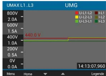
Anzeige – Sequenz einer Überspannung im Dreiphasen 3-Leitersystem
